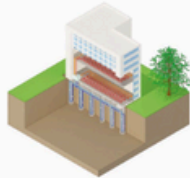
Pompe à chaleur sur géostructures énergétiques
