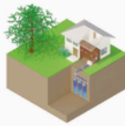
Pompe à chaleur sur corbeilles géothermiques
