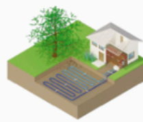
Pompe à chaleur sur capteurs enterrés horizontaux
